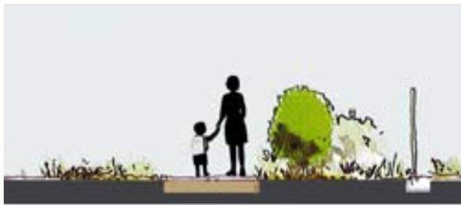
Deux exemples de traitement d'une interface entre l'espace public et l'espace privé : voirie véhicules, frange végétale enherbée, chemin piéton, frange végétale arbustive et dispositifs de clôture à base de mur maçonné (aux abords des accès par exemple) ou clôture simple.
